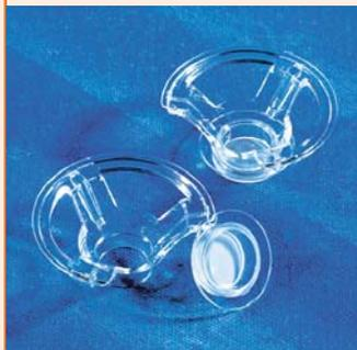
带有聚碳酸酯膜（下）和聚酯膜（上）的Snapwell嵌套
